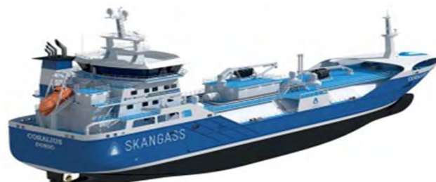
LNG bunker tanker – Skangass
