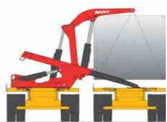
吊臂侧吊移动
